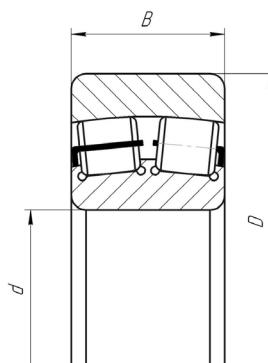
**ŁOŻYSKA BARYŁKOWE, DWURZĘDOWE, Z KOŁNIERZAMI NA PIERŚCIENIU WEWNĘTRZNYM
