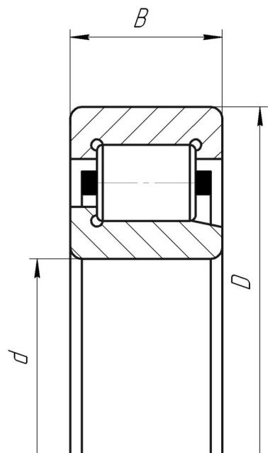
CYLINDRICAL ROLLER BEARINGS WITH ONE
