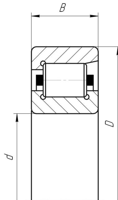
CYLINDRICAL ROLLER BEARINGS WITH ONE INTEGRAL
