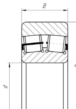
**ŁOŻYSKA BARYŁKOWE, DWURZĘDOWE, Z KOŁNIERZAMI NA PIERŚCIENIU WEWNĘTRZNYM
