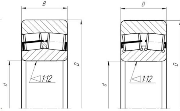
**ŁOŻYSKA BARYŁKOWE, DWURZĘDOWE, Z KOŁNIERZAMI NA PIERŚCIENIU WEWNĘTRZNYM
