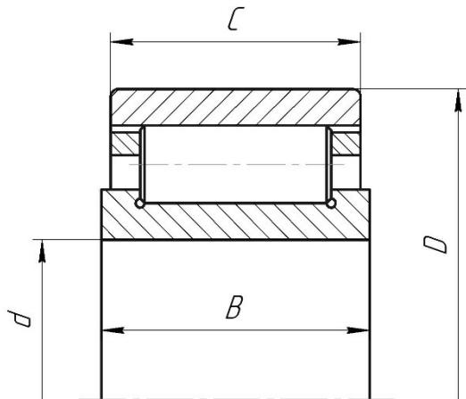
ŁOŻYSKA IGEŁKOWE Z KOŁNIERZAMI NA PIRŚCIENIU WEWNĘTRZNYM I BEZ KOŁNIERZY NA PIRŚCIENIU ZEWNĘTRZNYM
