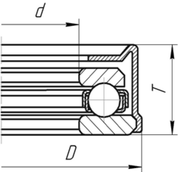
ŁOŻYSKA KULKOWE WZDŁUŻNE JEDNOKIERUNKOWE Z
