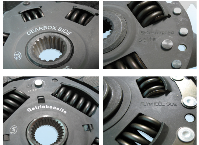
Kuva 1-4: Mahdolliset merkinnät kytkinlamellissa
